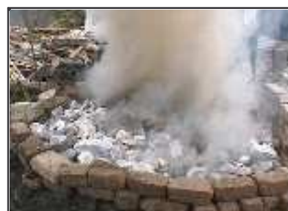
four à plâtre (doc.Le Gabion)
